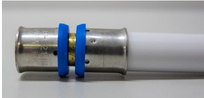
Kontrolle der Einstecktiefe durch Sichtfenster
